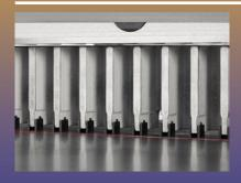
La table est protégée des frottements de la butée arrière par des racleurs en plastique montés sur ressort.
